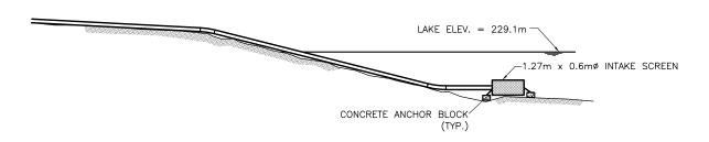
ELEVATION - WATER INTAKE WITH FISH SCREEN
