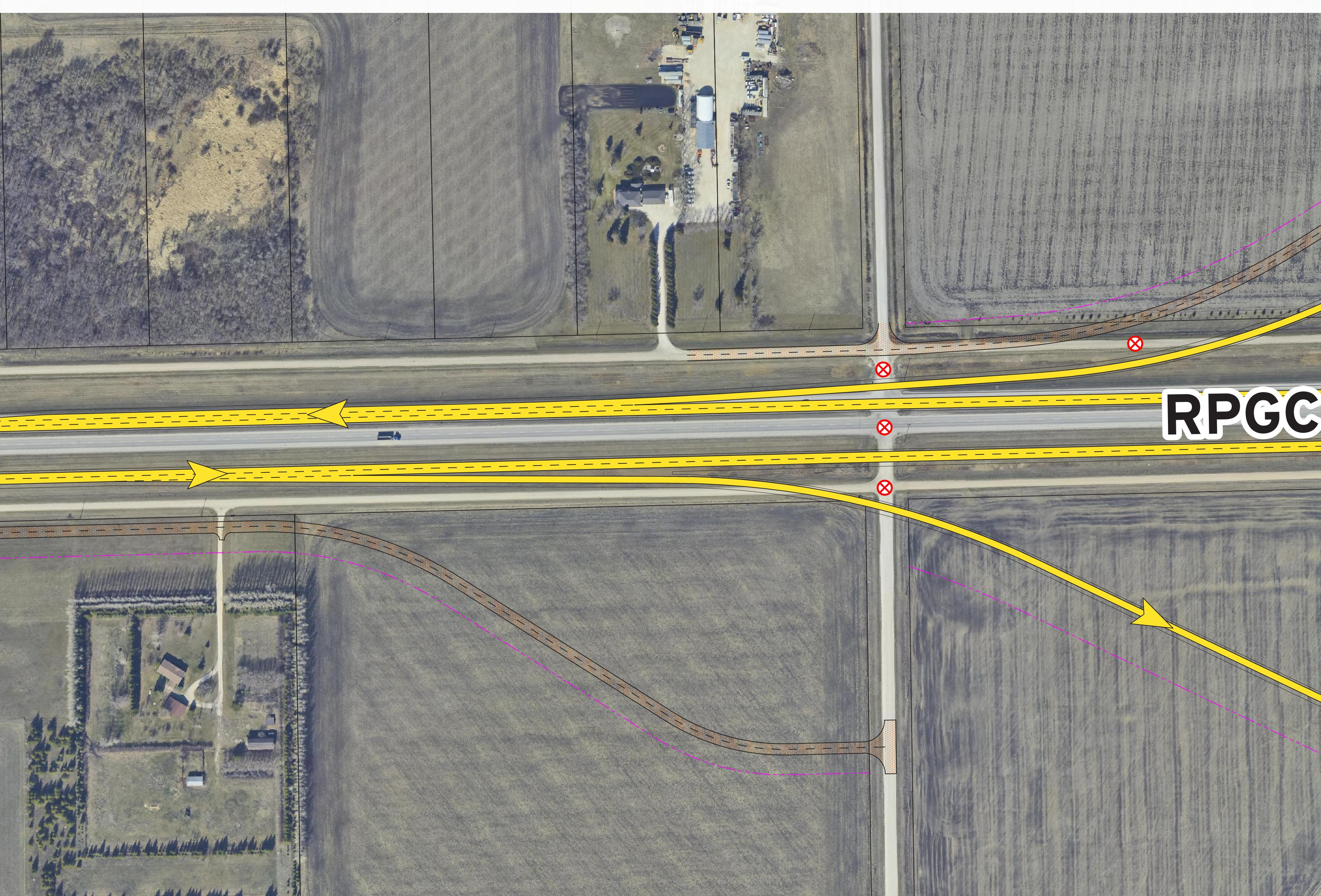
Ce plan nécessite le moins d'acquisitions foncières, a les meilleures prévisions de la circulation et maintient la connectivité par l'intermédiaire de la RPS 221. Le plan combine l'échangeur avec le passage supérieur ferroviaire et élimine donc un deuxième passage supérieur sur la RPGC 101.
