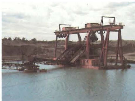
Excavateur flottant à double benne preneuse, utilisée dans le gisement de gravier de Birds Hill, 1982.
