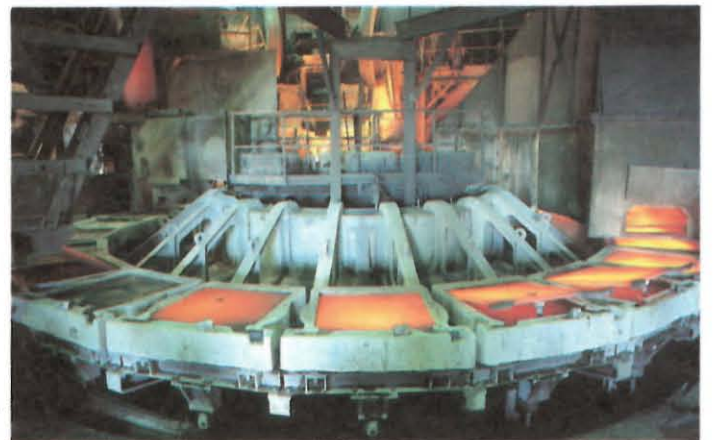
Le cuivre en fusion est moulé en anodes pesant environ 240 kilogrammes qui seront transportées ultérieurement à Montréal.
