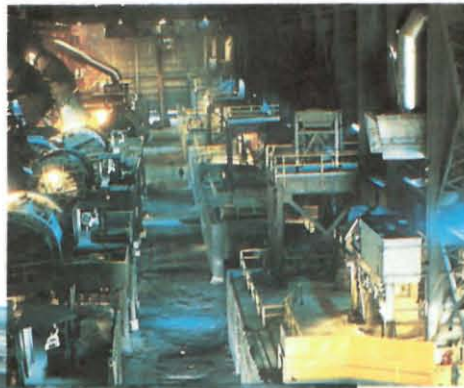
Extrême droite : Concassage et broyage du minerai dans les concentrateurs de l'usine de Thompson, 1980.
