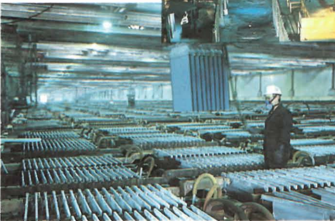
Dans la chambre des cuves de Hudson Bay, on dépose du zinc sur des cathodes dans 1 180 cellules électrolytiques. On voit ici un ouvrier transportant un jeu de cathodes, 1986.
