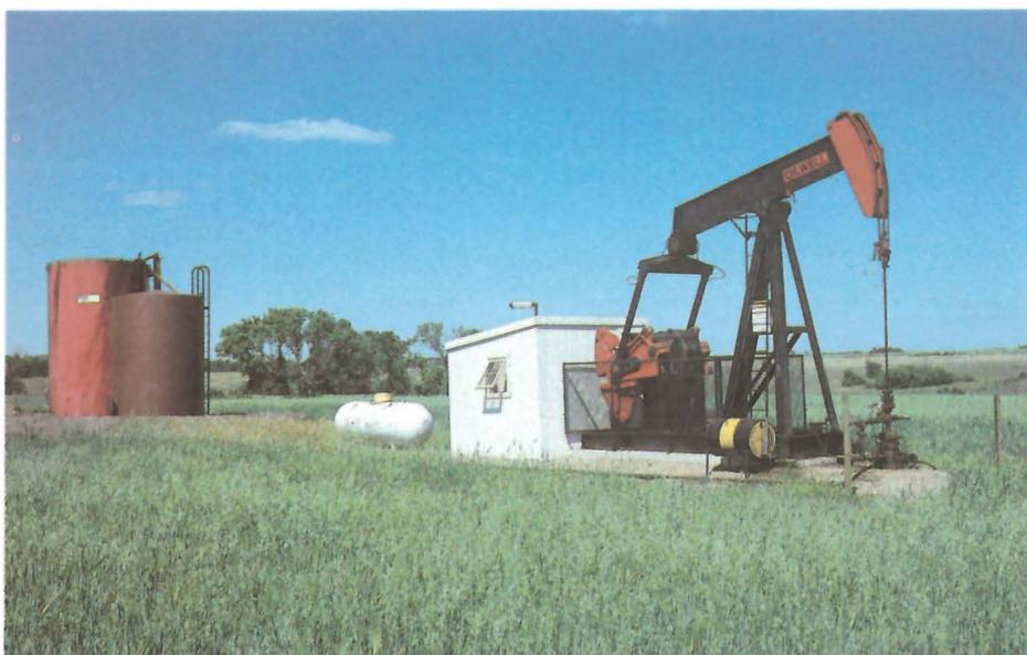
Puits pompé et réservoirs de production servant au stockage avant l'acheminement du pétrole en direction des pipelines et de l'eau en direction des puits d'évacuation de l'eau salée ou des puits d'injection; région de Lyleton, Manitoba.
