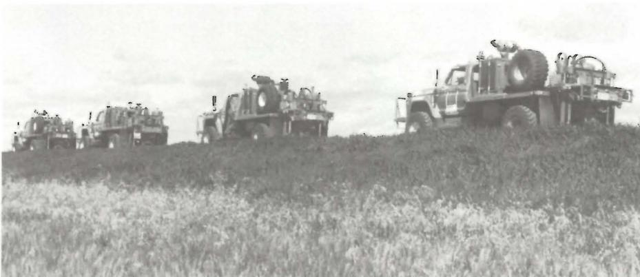
Utilisation d'un procédé de sismique-réflexion fondé sur l'émission d'ondes sonores à la surface de la terre, rendant inutile le forage ou les explosifs.
