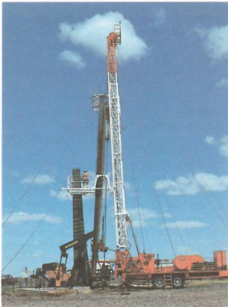
*On utilise des appareils de forage auxiliaires pour la préparation des puits en vue de la mise en production ou de toute autre opération subséquente.*
