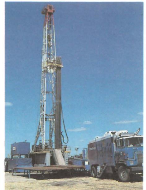
Camion-laboratoire sur le site d'un forage, près de Pierson, au Manitoba; on utilise la diagraphie pour déterminer la nature, la quantité et la profondeur des fluides présents dans les formations.
