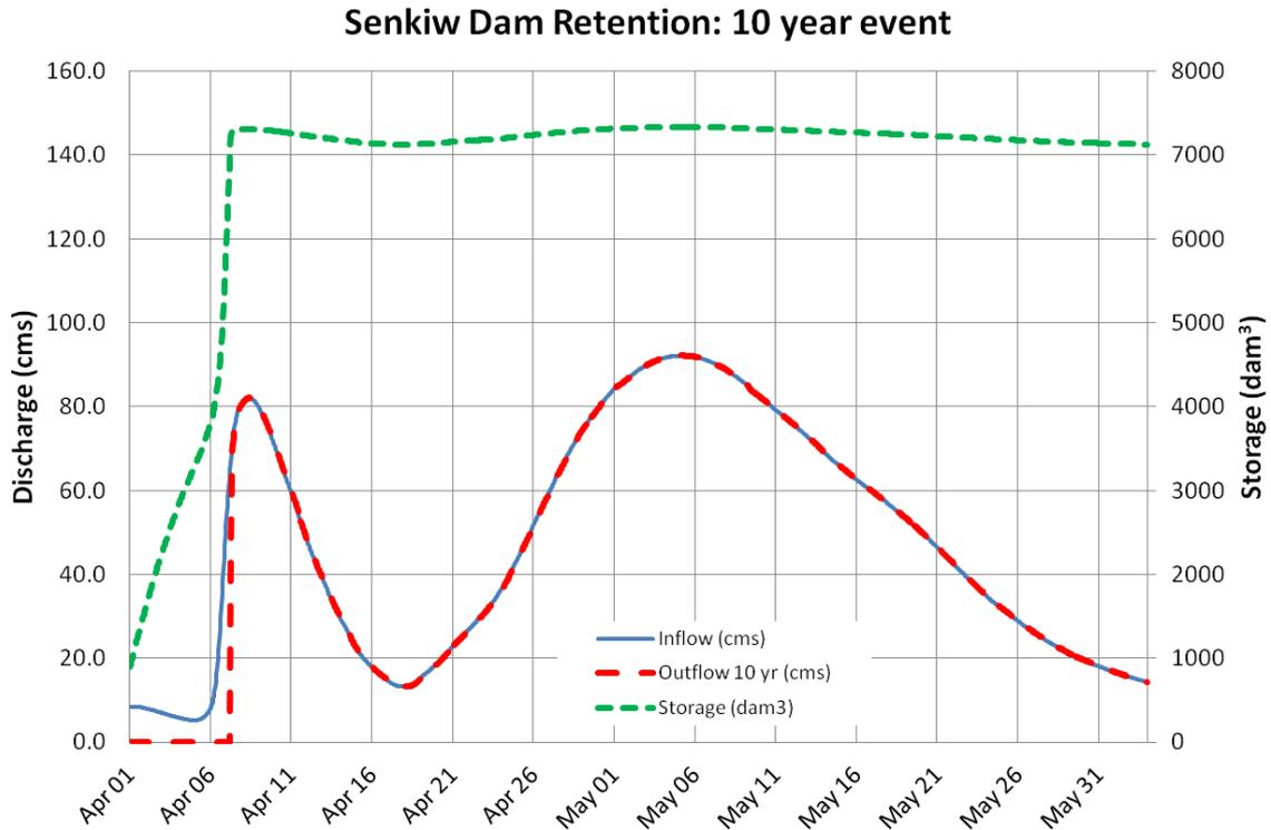
**Figure 35: Senkiw Dam Retention Effects**
